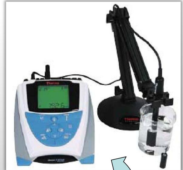
**La determinación de fluoruro se realizará mediante potenciometría directa que se basa en la construcción de una **Curva de Calibración** utilizando un electrodo sensible al  $F^-$  o ISE para el  $F^-$ . A partir de la C.C. se calculará la concentración de fluoruro en las muestras.**
