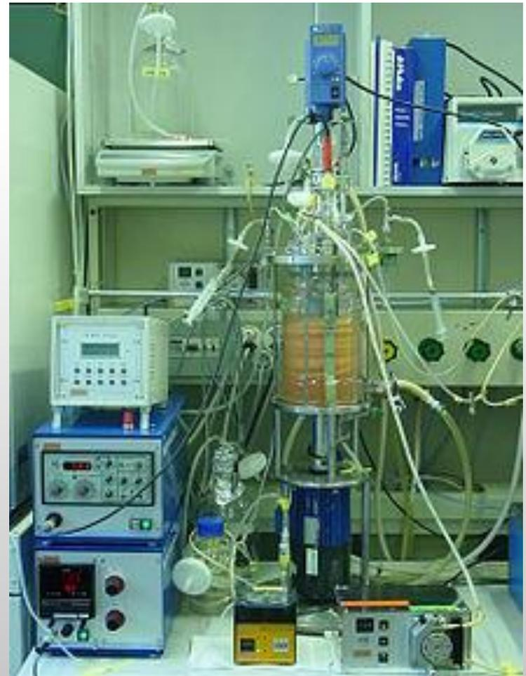
*Biorreactor a escala de laboratorio contiene células animales esta controlado por múltiples sondas de  $\text{CO}_2$ ,  $\text{O}_2$ , pH.*
